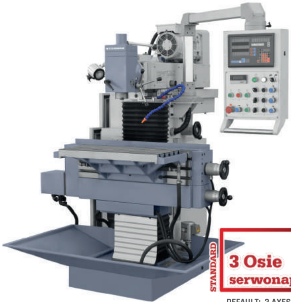
DEFAULT: 3 AXES SERVMOTOR
