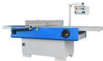
Фуговальный станок по дереву DMA 53L
